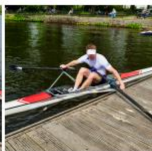
03. Dollenstifte wasserseitig lösen und die Dole öffnen.
