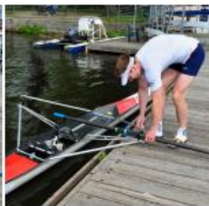
02. Dole wird geöffnet und das Skull richtig eingelegt.
