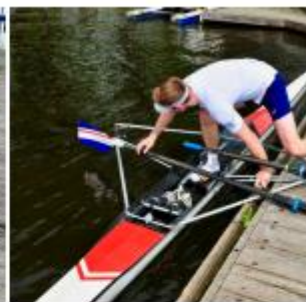
03. Skull wird wasserseitig eingelegt; Dollen schließen.
