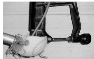
Elastik über Dolle spannen und Tennisball über Dollenstift stülpen
